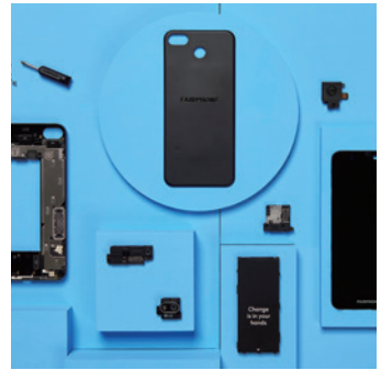
Fairphone的模组设计，不仅容易置换维修，零组件的原料取得也特别讲究人道与环保。
